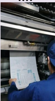
（左）④最新のアルミ刷版を輪転機に装着する光景(ソウル五輪当時は樹脂製でした)
